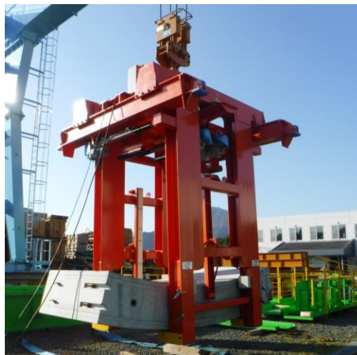
↑アームが左右両側から内側に平行スライドしてセグメントを掴み、クレーンにより移動させています。 (当社関西マシーナリにて試運転)
