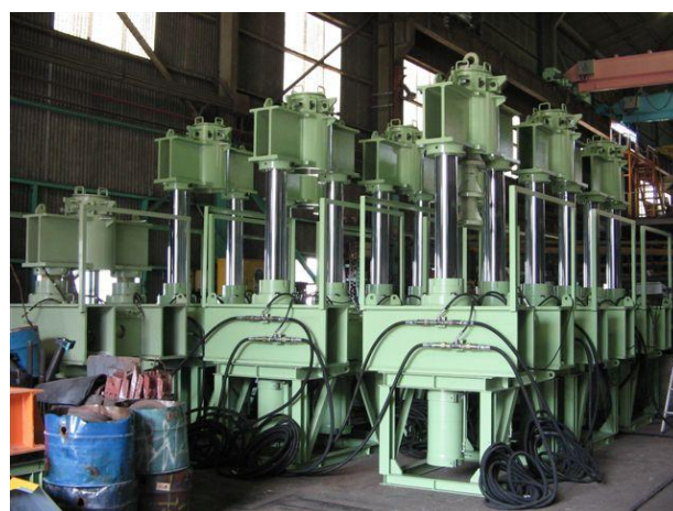
K-G圧入装置工場作動テスト状況
