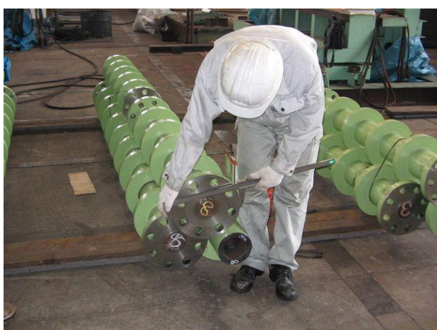
テンションバー寸法検査状況
